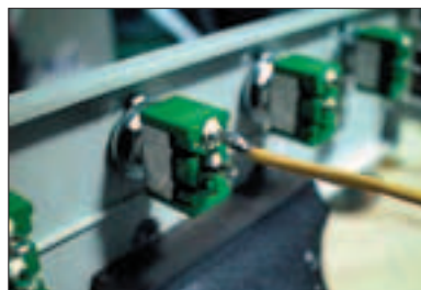
Припаиваем провода питания
