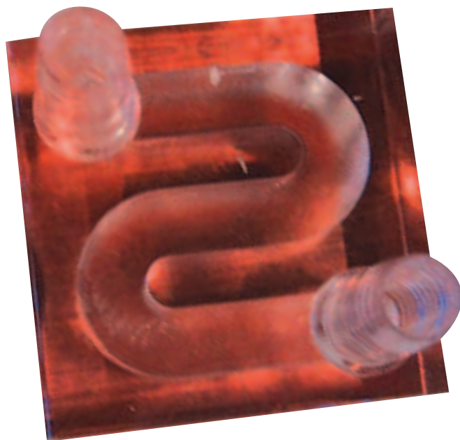
Готовый теплообменник северного моста материнской платы
