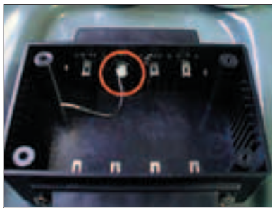
Припаиваем первый провод
