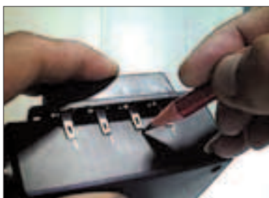
Намечаем карандашом положение контактов пружинных клемм
