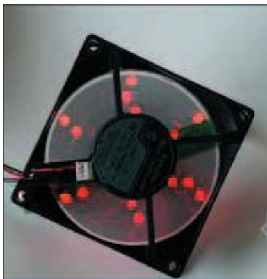
Одно из множества состояний светящегося вентилятора, подключенного к схеме строба
