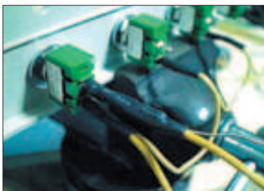
Не забудь надеть изоляционную трубку
