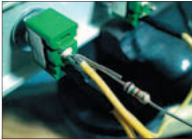
Припаиваем одновременно провод и резистор
