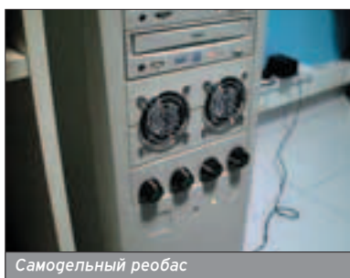
Самодельный бэйбас типа 5/off/12 (синий светодиод является индикатором 5 В, красный - 12 В)
