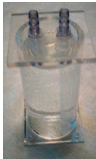
Резервуар, изготовленный из плексигласовой трубы
