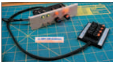
Бэйбас Клиффа Андерсена с двумя переключателями типа 7/off/12 для подключения нескольких мощных вентиляторов к каждому и с двумя ручками переменного резистора для менее мощных вентиляторов
