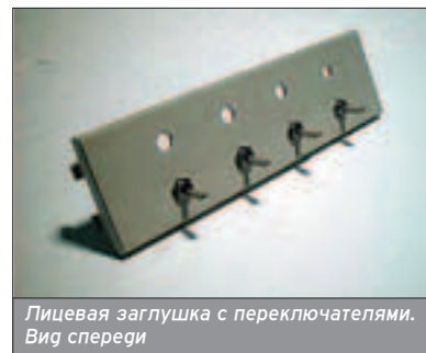
Обычная лицевая заглушка и заглушка с отверстиями под диоды и переключатели
