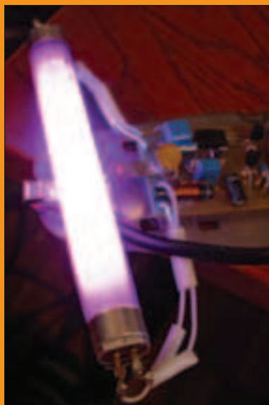
УФ лампа с преобразователем от автомобильной неонки
