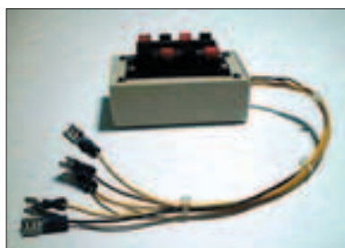
Фэнбас, готовый к подключению к панели бэйбаса
