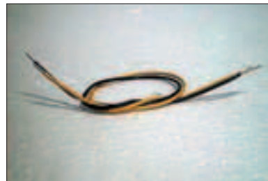
Желтый и черный провода для подсоединения фэнбаса к БП
