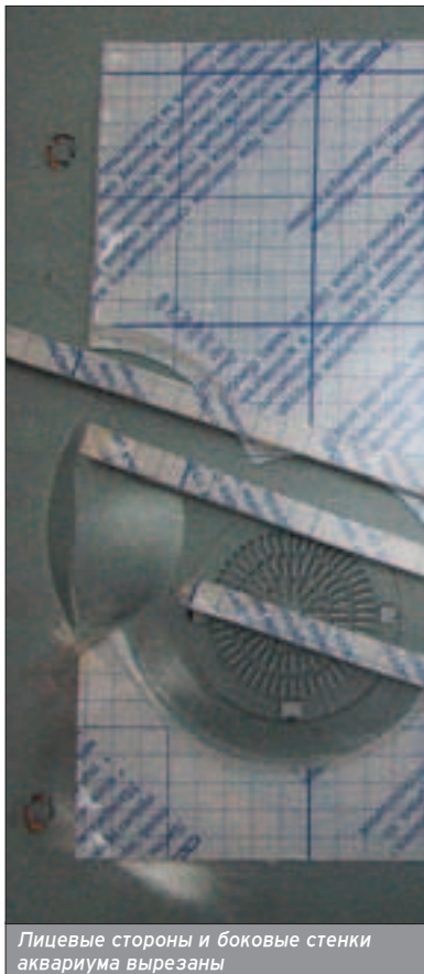
Кромки оргстекла по отверстию в боковухе
