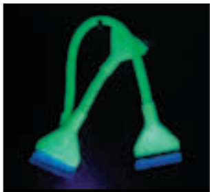
Зараунденный шлейф, светящийся в ультрафиолете
